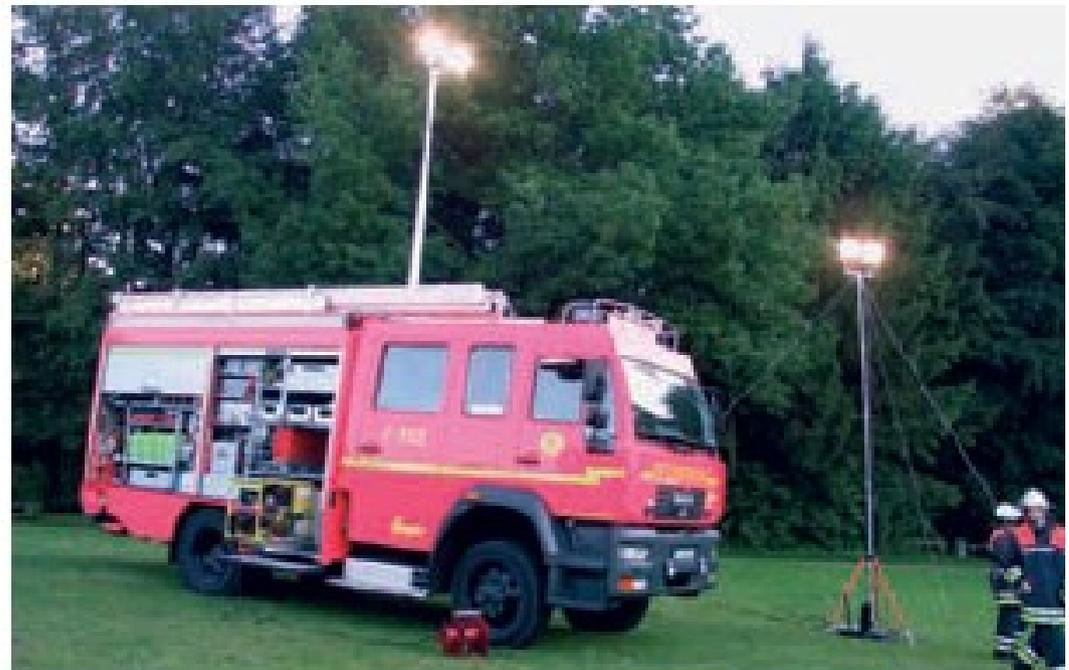
Lichtmast am Löschfahrzeug und abgespanntes
