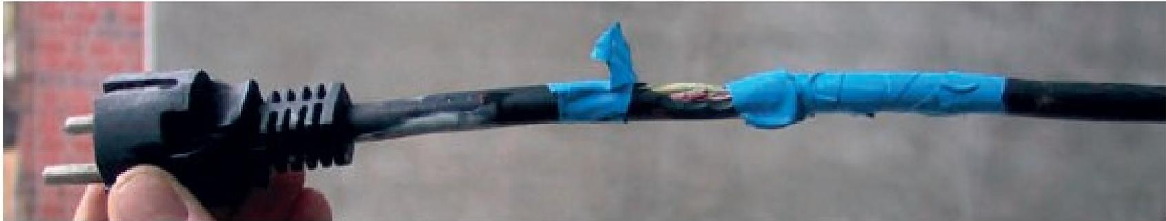
Der Isolationsschaden der Elektrozuleitung ermöglicht das direkte Berühren des unter Spannung stehenden Leiters.
